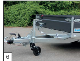
Serienausstattung: verstärktes, klappbares Stützrad montiert.
