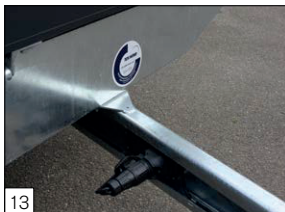
Serienausstattung: Widerstands- unit montiert für die LED- Beleuchtung.
