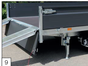
Serienausstattung: U-Profil an der Heckseite.
