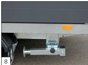
Serienausstattung: die Kürbelstützen sind verstellbar und 90° drehbar.
