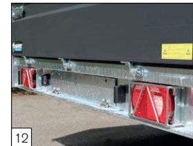
Serienausstattung: LED- Beleuchtung an der Heckseite.
