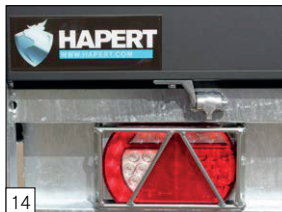
Serienausstattung: Abschilderung der Heckleuchte montiert.
