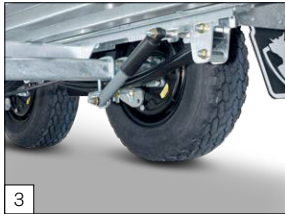
Serienausstattung: Parallel Federung montiert inkl. Stoßdämpfer.
