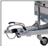
Alle gebremsten Modelle verfügen über eine geschraubte V-Deichsel, ein stabiles klappbares Stützrad und eine robuste Auflaufbremse mit gegossener Kugelkupplung.
