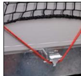
An den H-Modellen sind runderherum speziell entwickelte Scharnierrohre angebracht. Das Ladungsnetz lässt sich mit dem Haken problemlos befestigen.
