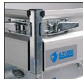
Die gesamte Azure-Reihe verfügt über die HAPERT-Verriegelung: eine robuste und einfach bedienbare, integrierte Zieh-Schub-Verriegelung, die flache (Seiten-) Wände gewährleistet. An der Rückwand aus Aluminium sind Heckklappenseile montiert.
