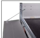
Die H-Modelle sind an der Heckseite mit einem U-Profil ausgerüstet. Außerdem wurden sie so konzipiert, dass nachträglich ein Aufbewahrungsfach mit Auffahrschienen unter dem Boden angebracht werden kann (mit Ausnahme des Modells H 260 x 150 cm).
