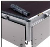
Die H-Modelle (Hochlader mit Ladefläche über den Rädern) werden mit eloxierten, herunterklappbaren Aluminiumwänden, einer Vorderwand mit Scharnier und herausnehmbaren Eckrungen geliefert.
