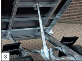
**Serienausstattung:** ausgestattet mit einem soliden, 3-stufigen Hydraulikzylinder.
