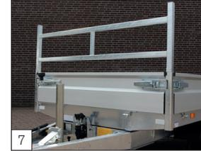
**Option:** abnehmbares Frontgitter montiert.
