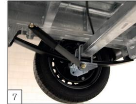
**Option:** Parabelfederung inkl. Stoßdämpfer und Bereifung mit schwarzen Felgen.
