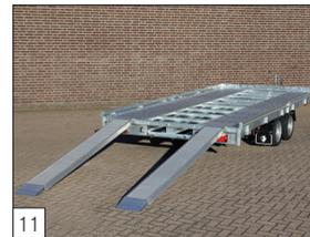
**Option:** 2 Fahrspuren, 600 mm breit, anstelle einer Multiplex-Bodenplatte.
