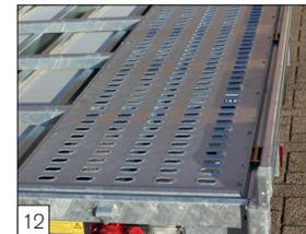
**Option:** die Fahrspuren sind mit einer Struktur mit ovalen, offenen Löchern versehen.
