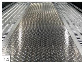
**Option:** Multiplex-Zwischenbodenplatte mit Aluminium-Riffelblech.
