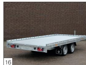
**Option:** Boden aus Aluminiumprofilen und Abschirmung der Heckleuchte montiert.
