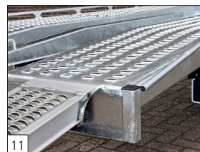
Serienausstattung: U-Profil bei abgeschrägter Heckseite.
