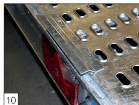
Serienausstattung: U-Profil mit Auffahrsschiene-Blockier-Konstruktion.
