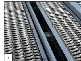
Serienausstattung: Auffahrsschienen mit offener Anti-Rutsch-Struktur.
