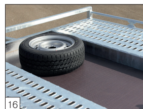
Option: Ersatzrad 195/50 R13 auf dem Zwischenboden.
