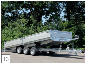
Option: die Modelle 5050 x 2000 mm und 5050 x 2200 mm sind als Dreiachser lieferbar.
