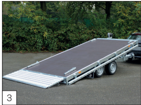
Option: die klappbare Combi Protect Rail ist ca. 110 mm hoch (Innenmaß ca. 50 mm schmaler).
