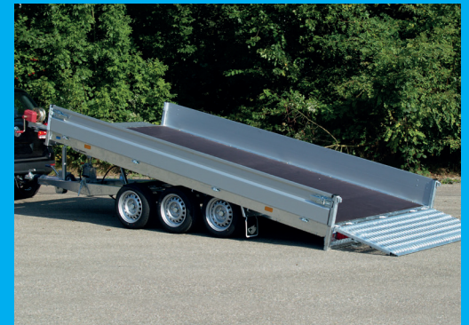
Serienausstattung: ausgestattet mit TÜV-geprüften Verzurrbügeln, integriert in den Seitenrahmen, jeweils mit einer Kapazität von 1000 daN.
