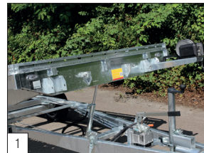
Serienausstattung: mit doppelwirkendem hydraulischen Kippsystem, verstellbarer Winde mit Halterung, 3,5 Tonnen-Auflaufeinrichtung und einer festen Combi Protect Rail (80 mm hoch).
