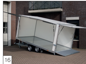
Option: Kofferaufbau serienmäßig mit Heckklappe 1000 mm nach unten klappend, und oberer Teil nach oben aufklappbar.
