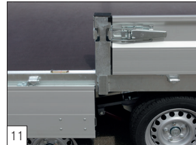
Option: Modelle mit einer Länge von 4550 und 5050 mm und Aluminium-Bordwänden sind serienmäßig mit herausnehmbaren Mittelrungen ausgestattet.
