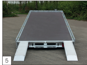
Option: Aluminium-Auffahrschienen in verschiedenen Längen möglich anstelle einer durchgehenden Heckklappe.
