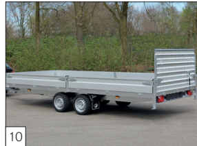
Option: Aluminium-Bordwände, 300 mm hoch, anstelle von Combi Protect Rail.
