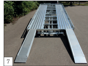
Option: 2x Fahrspuren, 600 mm breit, mit offener Lochstruktur anstelle einer Multiplex-Bodenplatte.
