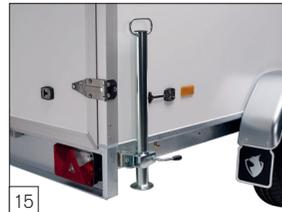
**Option:** Schiebstützen montiert.
