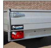
Die gesamte Basic L-Reihe besteht aus eloxierten, 35 cm hohen Aluminiumwänden, die sowohl auf der Innen- als auch auf der Außenseite mit Montagerillen ausgerüstet sind. Darüber hinaus verfügt dieses Modell über eine solide Heckklappe mit 2 professionellen und leicht bedienbaren Zieh-/Schub-Verschlässen.
