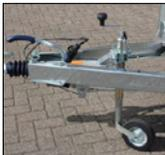
Alle Basic H-Modelle sind mit einer verzinkten V-Deichsel ausgestattet. Die gebremsten Modelle verfügen zudem auch über ein stabiles Stützrad. Darüber hinaus ist die gesamte Basic H-Reihe mit der „HAPERT“-Verriegelung - in die (Seiten-)Wände integrierte, leicht bedienbare Zieh-/Schub-Verschlüsse - ausgerüstet.
