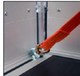
Die Anhänger sind serienmäßig mit TÜV-geprüften Zurrbügeln versehen, die eine Kapazität von jeweils 400 kg aufweisen.
