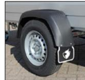
Die ungebremsten Basic L-Modelle sind mit Reifen der Größe 155/R13 ausgestattet. Die gebremsten Ausführungen haben sogar die Reifengröße 165R13C.
