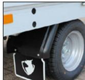
Die besonders niedrige Ladefläche (ca. 56 cm) wird u. a. durch die Verwendung von Reifen der Größe 18,5 x 8,5-8 bei ungebremsten Basic H-Modellen und der Größe 195/55R10C bei gebremsten Modellen erzielt.
