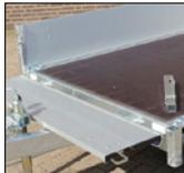
Die H-Modelle (Hochlader mit der Ladefläche über den Rädern) werden mit eloxierten, herunterklappbaren, 30 cm hohen Aluminiumwänden, einer Vorderwand mit Scharnieren und 4 robusten, herausnehmbaren Eckkrungen geliefert.
